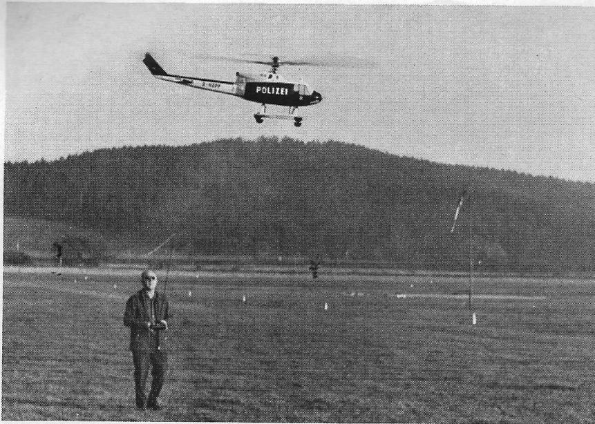
Ein schneller Vorbeiflug für die Kamera. In dieser Höhe sind auch Schwebeflüge relativ einfach, da die Maschine aus dem Bodeneffekt heraus ist. Hubschrauber darf man nicht so weit wegfliegen lassen wie RC-1-Modelle, sonst ist ihre Fluglage sehr schwer erkennbar.
